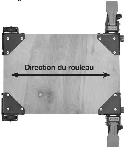
Une base étroite et courte, telle que l'on trouve sur une foreuse à colonne ou sur une scie à ruban, peut bénéficier de cet arrangement. En raison de la rotation pivotante, la base peut se situer hors niveau. Distancer la roue pivotante de la base en la tournant pour corriger.
